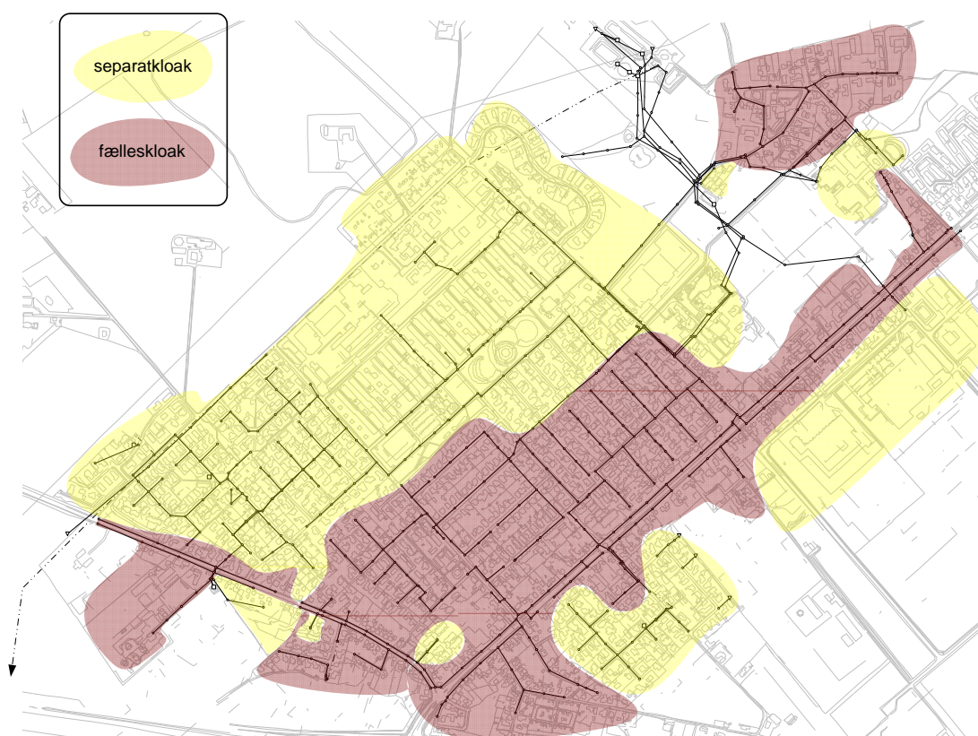
Figur 2. Omtrentlig afgrænsning mellem separat- og fælleskloakerede oplande.
