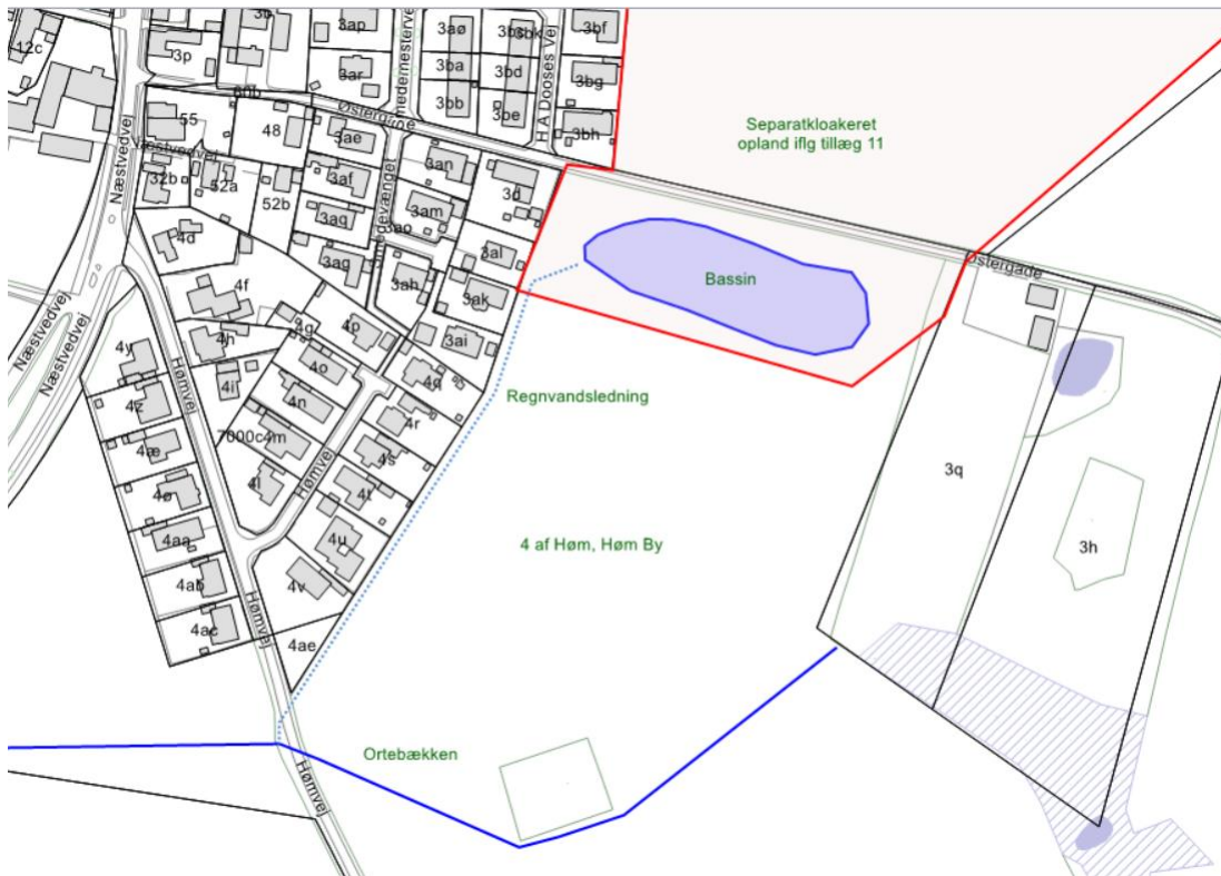
Figur 2. Placering af bassin og regnvandsledning
